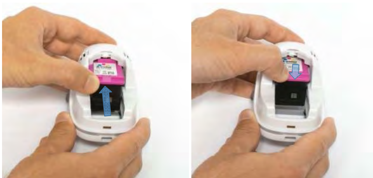
Obr. 15: Vložení inkoustové náplně
