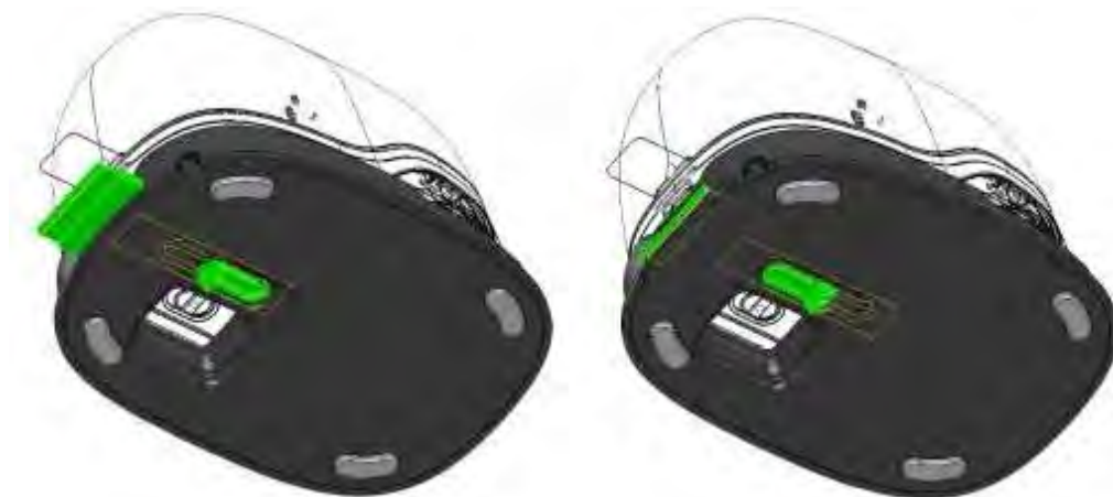
Obr. 30: Vysuňte stěrač tiskové hlavy
