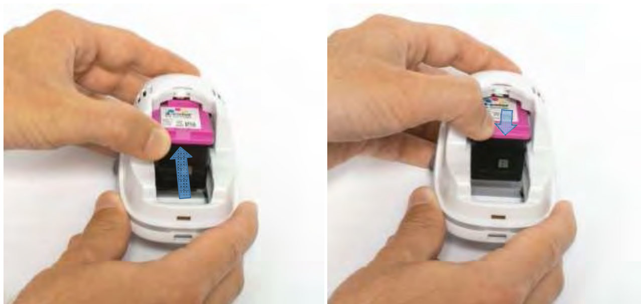
Obr. 49: Vložení inkoustové náplně
